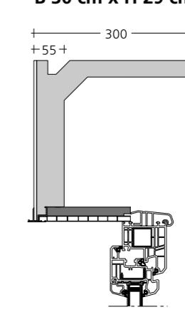
Der Kastenkörper aus homogen geschäumtem Polystyrol-Hartschaum. Eingelassene Sicken sorgen für eine optimale Verbindung zum Sturz.
