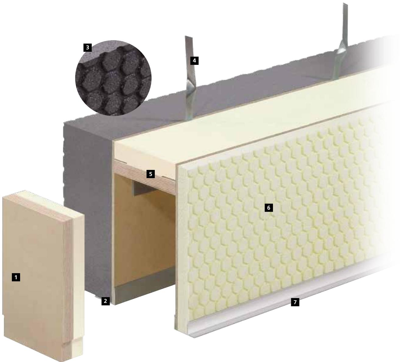
**1** 21 mm Multiplexplatte als Abschluss des Paket-Raums, hier optional mit Kopfstückdämmung.
